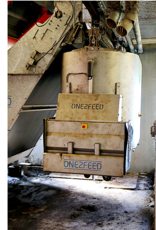
DANSK LEVERANDØR: Fôrvogna i det fullautomatiske fôringsanlegget fra One2Feed er i rustfritt stål, solid og enkel – akkurat det jærbonden var ute etter.
