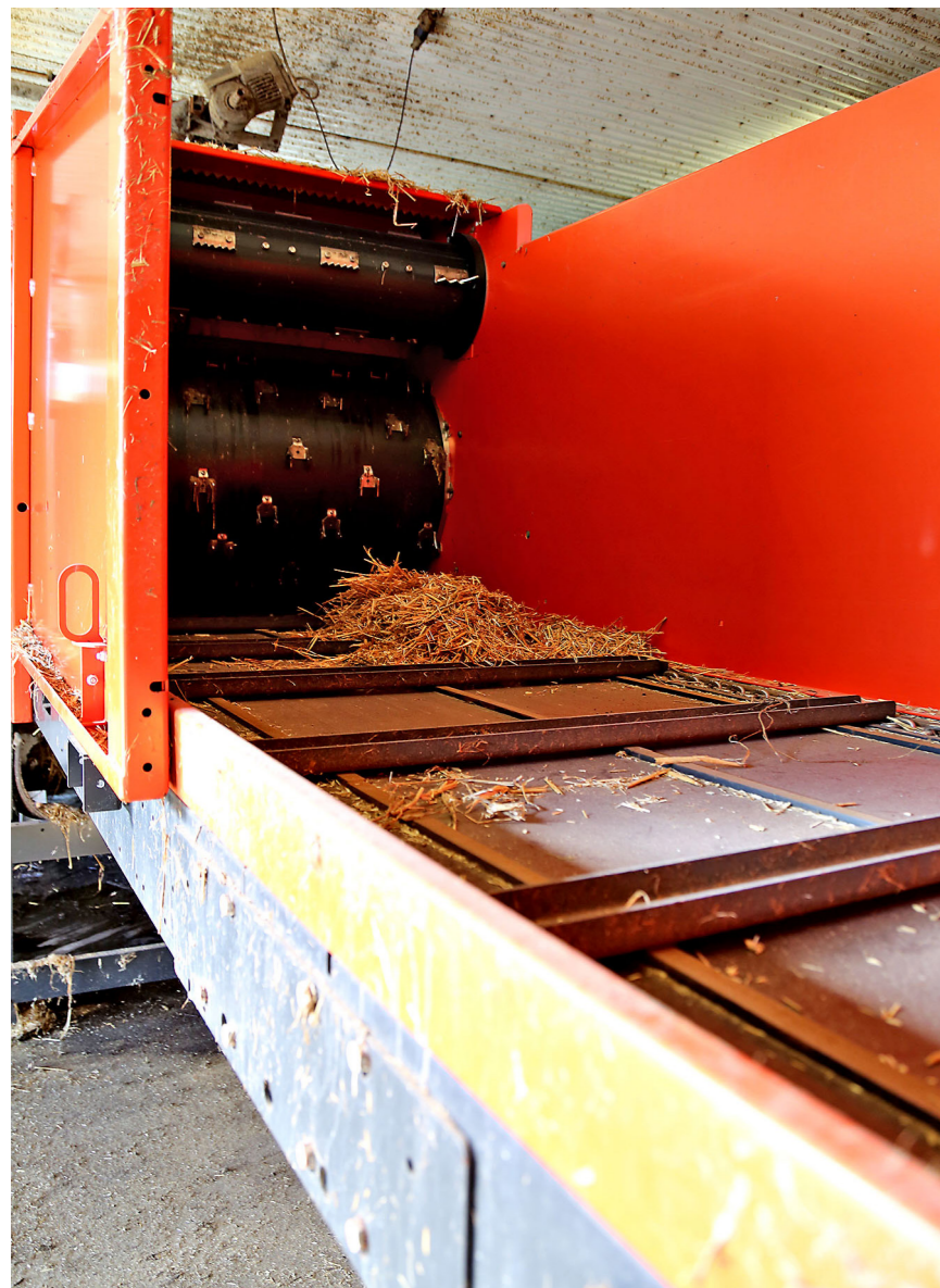
BIG BALE HALMRIVER: Halmrivieren fra TKS er bygd inn som en del av fôringsanlegget, noe som ifølge bonden fungerer utmerket.
